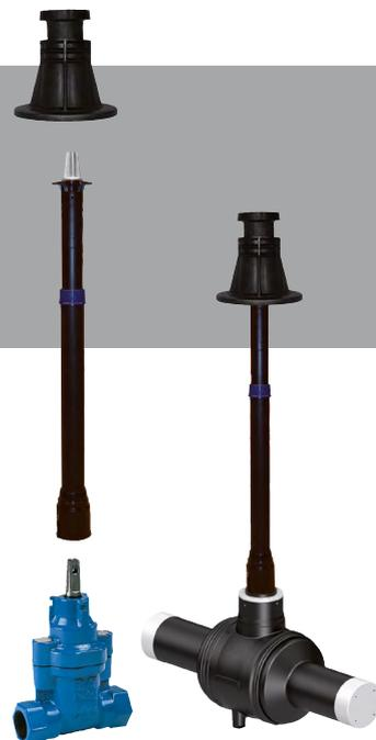
Die optimale Überdeckung der Spindel der Einbaugarnitur (=Distanz zwischen Oberkante Spindel zur Oberkante Straßenkappe) kann unter Verwendung der AVK Tragplatte Größe 1 „FSL“, mit Aufnahmetaschen für Einbaugarnituren automatisch sichergestellt werden. Ansonsten empfehlen wir, mindestens 50 mm Platz zu lassen.
