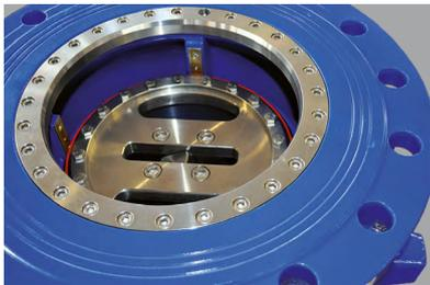
AVK Ringkolbenventile reduzieren oder regulieren hohe Druckdifferenzen und Durchflussmengen. Aufgrund des ringförmigen Durchflussquerschnitts in jeder Öffnungsstellung ist eine gezielte Regelung durch das stufenlose axiale Verschieben des Kolbens möglich.
