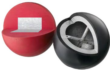
Die Kugelrückschlagventile von AVK sind selbstreinigend und vollöffnend. Sie können in horizontaler und vertikaler Position eingebaut werden. Die Kugel dreht sich im Betrieb und verhindert so, dass Verunreinigungen an der Kugel anhaften. Der volle, glatte Durchgang gewährleistet vollen Durchfluss mit geringem Druckverlust und schützt vor Rückstandsbildungen am Boden.
