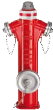
Typ P7 NIRO Serie 84/72 Überflurhydrant in Umfahrausführung mit zusätzlicher Kugelabspernung DIN EN 14384 (DIN 3222) Bauart C PN 16 DN 80/100
