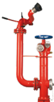
Typ P7 MONITOR Serie 84/95-96 ähnlich DIN EN 14384 (DIN 3222) ohne Umfahrtrennstelle mit zusätzlicher Kugelabspernung mit Absperrventilen "Easy-Open" DN 100, PN 16 Monitoraufbau mit Einklemmklappe Typ EVBS nach DIN 3202 (Abb. zeigt Modell P5)
