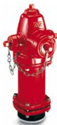
Serie 27 Überflurhydrant "modern" Einbautiefe 2' bis 6' (60,96 cm - 182,88 cm) DN 100/150, PN 17,2 UL/ULC registriert (DN 150) FM Zulassung (DN 150)
