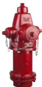
Serie 27/00 Überflurhydrant "modern" Einbautiefe 305 - 2438 mm 17,2 bar (250 PSI) Duktilguss UL/ULC registriert, FM Zulassung
