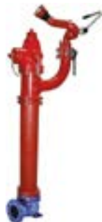
Serie 27 Überflurhydrant mit Monitor Einbautiefe 305 - 2438 mm 17,2 bar (250 PSI) Duktilguss UL/ULC registriert, FM Zulassung
