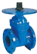
Serie 45/59 Keil-Flachschieber mit Montageplatte für Überfluröffnungsanzeiger DN50 - DN300: 17,2 bar/250 PSI DN350 - DN400: 13,7 bar/200 PSI Duktilguss UL/ULC registriert, FM zugelassen
