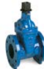
Serie 45/59 Keil-Flachschieber mit Montageplatte für Überfluröffnungsanzeiger DN50 - DN300: 17,2 bar/250 PSI DN350 - DN400: 13,7 bar/200 PSI Duktilguss UL/ULC registriert, FM zugelassen
