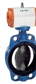
Serie 75/31 Absperrklappe Zentrisch mit aufvulkanisierter Manschette Semi Lug Type DN50-300 PN10/16 Sphäroguss
