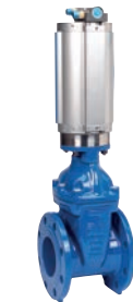
Serie 715 Absperrschieber mit hydraulischem Antrieb DIN F4 DN65-300 PN10/16 Keilgummierung NBR Sphäroguss
