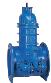
Serie 55/30 Absperrschieber DN450-500-600-800 DIN F5 PN10/16 Sphäroguss Widerstandsfähig sitzend Austauschbare Spindelabdichtung
