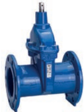
Serie 02/60 Absperrschieber DIN F5 DN40-500 PN10/16 Sphäroguss
