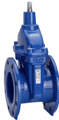
Serie 06/84 Absperrschieber DIN F4 DN40-600 und 800 Keilgummierung NBR Sphäroguss AB DN450 mit ISO-Flansch
