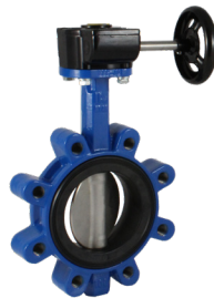
Serie 820/10 Absperrklappe Zentrisch mit austauschbarer NBR-Manschette Lug Type DN25-600 Sphäroguss
