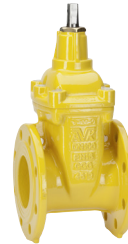
Serie 06/70 Absperrschieber DIN F4 DN40-600 Keilgummierung NBR Sphäroguss
