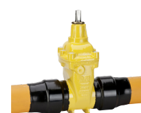
Serie 36/90 Absperrschieber mit PE-Enden DN65-400 Keilgummierung NBR Sphäroguss
