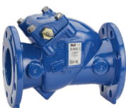
Serie 41/60 Rückschlagklappe Weichdichtend mit freiem Wellenende DN50-300 Sphäroguss
